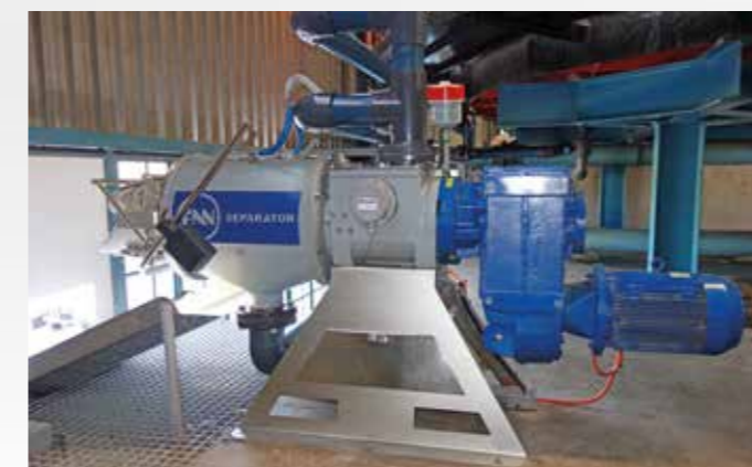
PSS – Separation von Weißwasser in Kombination mit einer Flotationsanlage / PSS – Separation of white-water runoff in combination with a DAF unit
