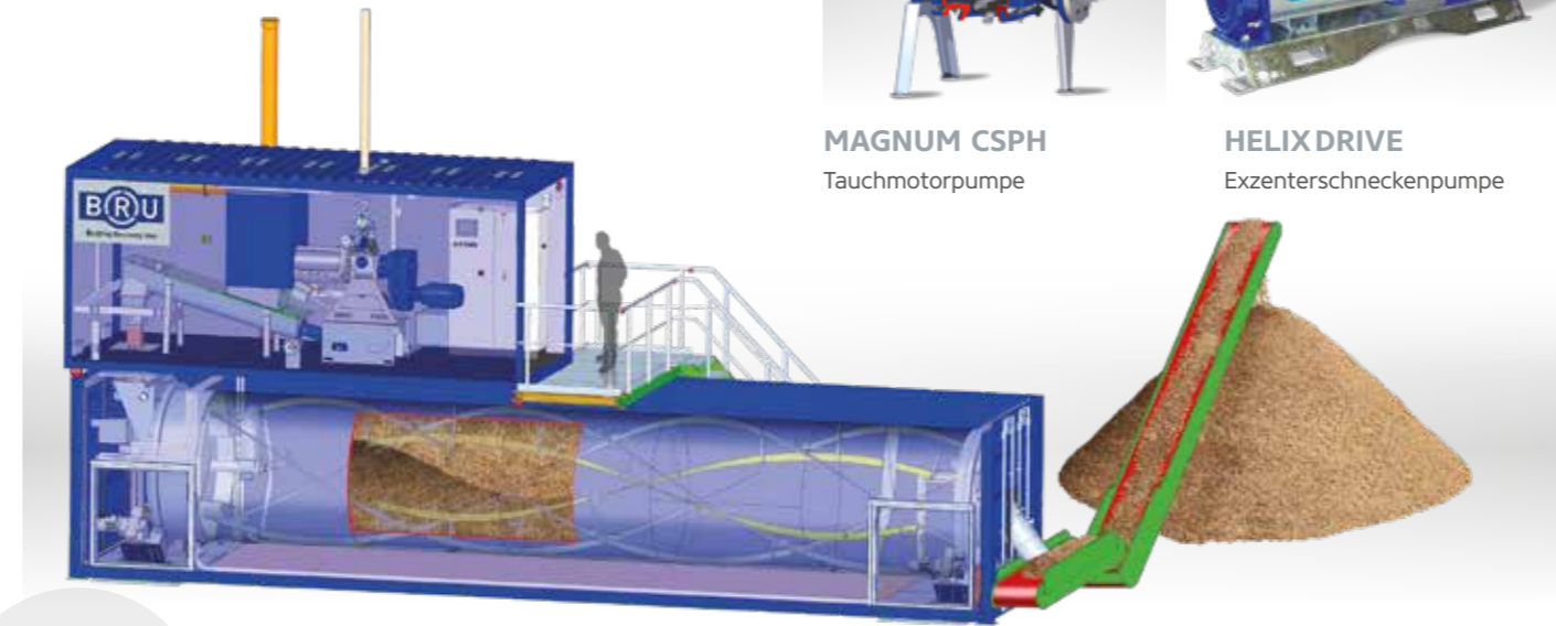
BRU Bedding Recovery Unit produziert frisches Bio-Einstreumittel aus Schlamm
